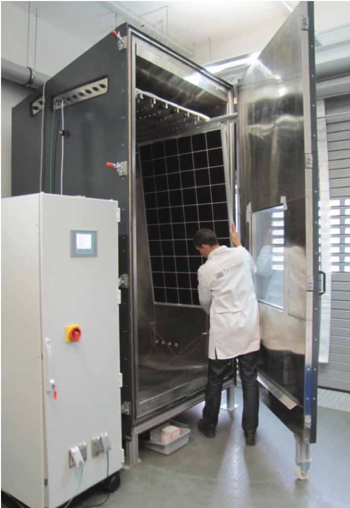
Beispiel für anspruchsvolle Testaufgaben: Ein PV-Modul wird in der Schadgaskammer für einen Ammoniaktest vorbereitet
