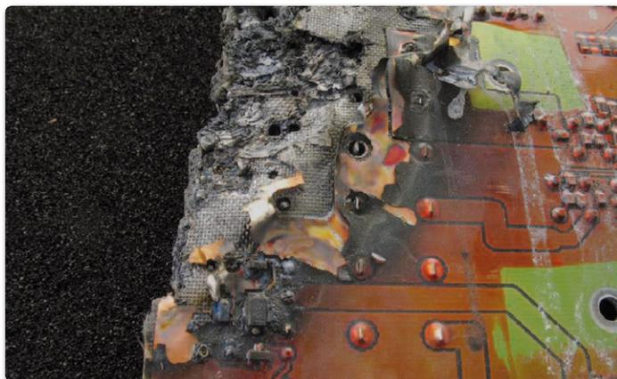
Bild 2: Brandschaden an einer Platine
