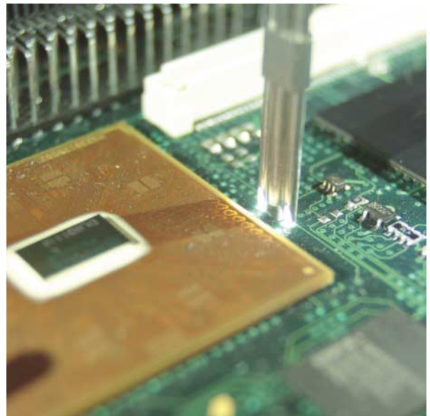
Bild 3: Inspektion mittels Nadelendoskop in ein Loch mit 1,5 mm Durchmesser zur Beurteilung von Bauteilen, die sich unter einer gelöteten, nicht lösbaren Hf-Abschirmung befinden
