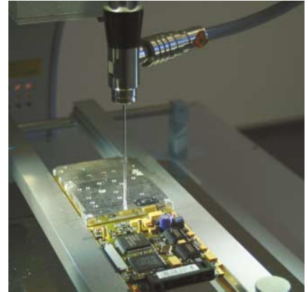
Bild 4: Endoskop zur seitlichen Betrachtung (z. B. für BGA-Inspektionen). Wichtig ist hierbei, dass das optische System eine kleine Geometrie über einem hohen Arbeitsabstand beibehält
