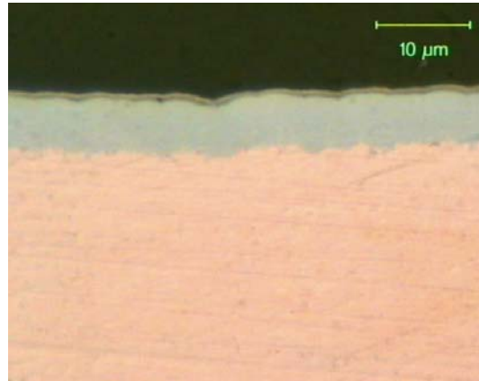
Abbildung 5: Außergewöhnliche Goldbadkorrosion an ungelöteter Leiterplatte, "Black Band"
